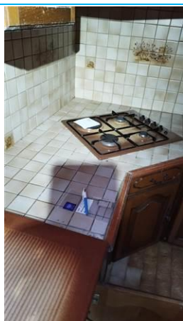
Matériaux : ZPSO-023 Prélèvement : P023 Description : Colle de carrelage plan de travail Localisation : Rez de chaussée - cuisine 2 Résultat : Absence d'amiante
