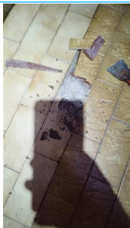
Matériaux : ZPSO-025 Prélèvement : P025 Description : Colle de carrelage clair Localisation : Rez de chaussée - cuisine 2 Résultat : Absence d'amiante
