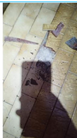
Matériaux : ZPSO-024 Prélèvement : P024 Description : Colle de carrelage foncé Localisation : Rez de chaussée - cuisine 2 Résultat : Absence d'amiante
